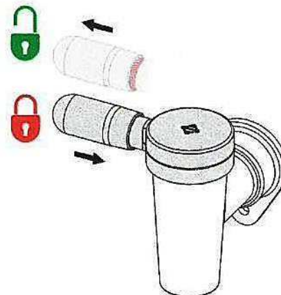
rys 14. Widok na zawór spustowy strawy w pozycji zamkniętej
