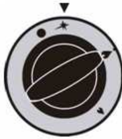
rys 18. Położenie pokrętki podczas zapalania palnika pilotującego
