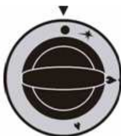
rys 21. Położenie pokrętki w pozycji „kurek gazowy zamknięty”
