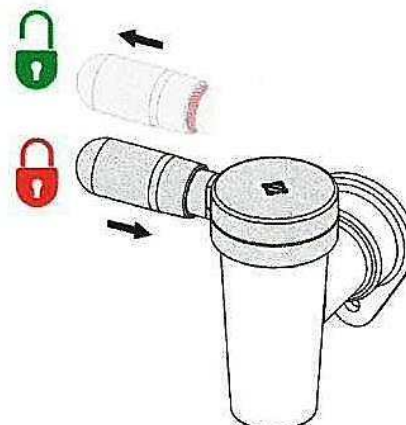
rys 17. Widok na zawór spustowy strawy w pozycji zamkniętej
