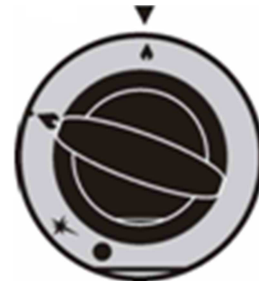
rys 20. Położenie pokrętki na płomień minimalny
