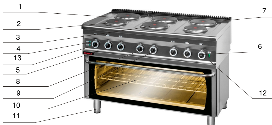
Rys.2. Budowa kuchni z piekarnikiem 1-płyta górna, 2-płytką grzejną 2kW 3-płytką grzejną 2,6kW, 4-lampka sygnalizacyjna grzanie płytek, 5-tablica, 6-pokrętła przełącznika zakresu grzania płyt grzejnych, 7-kominek, 8-przełącznik rodzaju grzania piekarnika góra-dół, 9-wyłącznik sprzężony z regulatorem temperatury, 10-drzwi komory piekarniczej, 11-noga z regulacją,
