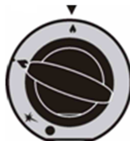
rys 12. Położenie pokrętła na płomień minimalny
