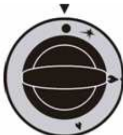
rys 13. Położenie pokrętła w pozycji „kurek gazowy zamknięty”
