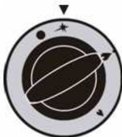
rys 10. Położenie pokrętła podczas zapalania palnika pilotującego
