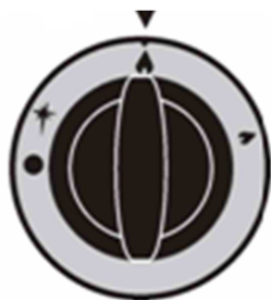
rys 11. Położenie pokrętła na płomień maksymalny
