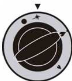
rys 9. Położenie pokrętła podczas zapalania palnika pilotującego
