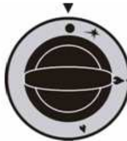
rys 12. Położenie pokrętła w pozycji „kurek gazowy zamknięty”
