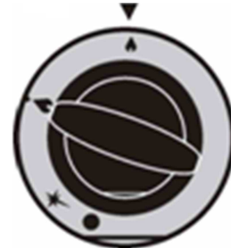
rys 11. Położenie pokrętła na płomień minimalny
