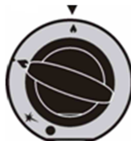
rys 11. Położenie pokrętła na płomień minimalny
