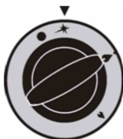
Rysunek 2. Położenie kurka podczas zapalania palnika zapalającego. „Płomień pełny”.
