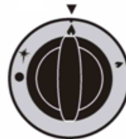
Rysunek 2. Położenie kurka podczas zapalania palnika zapalającego. „Płomień pełny”.
