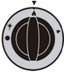
rys 14. Położenie pokrętła na płomień maksymalny
