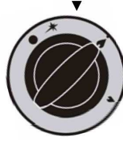
rys 13. Położenie pokrętła podczas zapalania palnika pilotującego w taborecie 000.TG-1s
