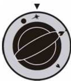
rys 12. Położenie pokrętła podczas zapalania palnika pilotującego w taborecie 000.TG-1, 000.TG-2, 000.TG-1f
