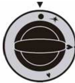
rys 16. Położenie pokrętła w pozycji „kurek gazowy zamknięty”
