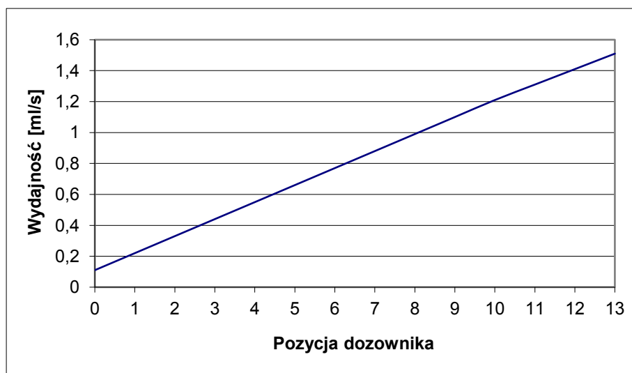
Wykres 1 - Wydajność dozownika płynu myjącego w funkcji nastawy pokrętła regulacyjnego
